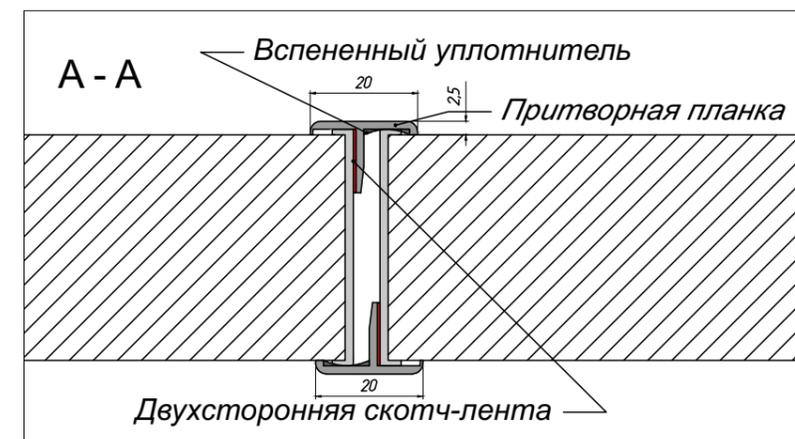
Вспененный самоклеящийся уплотнитель POR 300/60-4216 (наносится при монтаже)
