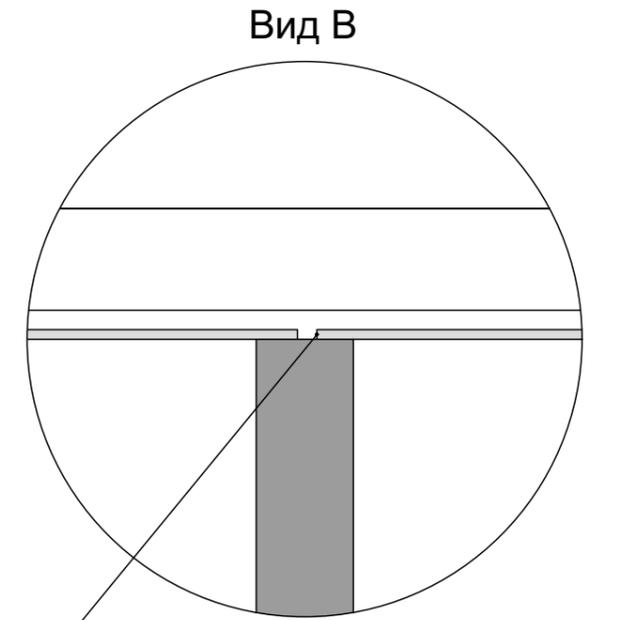
Притворная планка устанавливается между горизонтальными деталями кромки полотна
